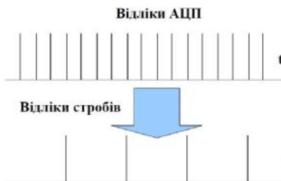
Рис. 1. Процедура децимації відліків аналого-цифрового перетворювача
