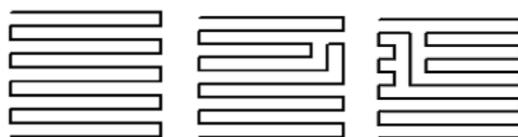
Рис. 2. Непетлевые вибраторы 10×10, синтезированные с помощью МАО.
