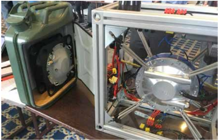
Електрогенератор компанії Ve-Rex (вписується у габарит каністри).
