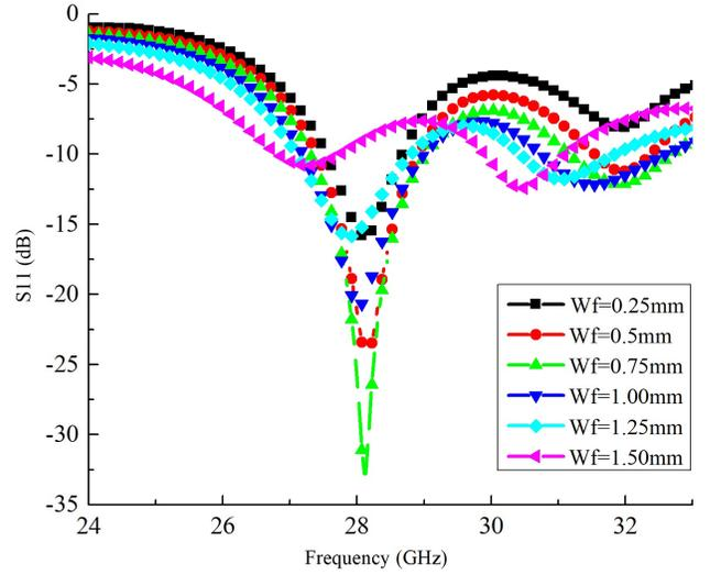
Fig. 2. Scattering parameter (S11) versus width ( $W_f$ )
